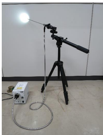
左：検討で使用したボアスコープとハイスピードカメラ、右：ボアスコープの観察像
