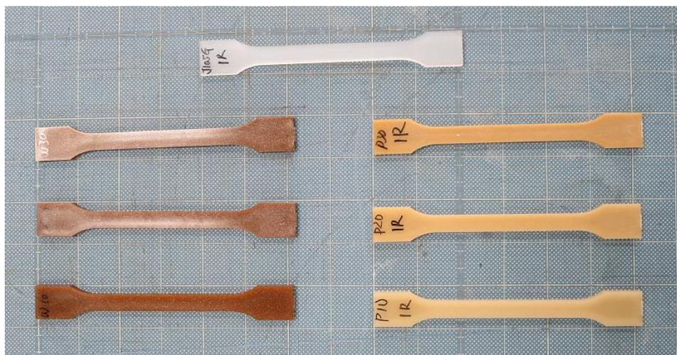
図1 試作したJIS1A型試験片
