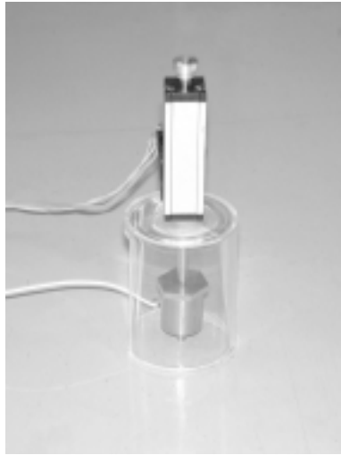
写真1 衝撃センサ外観
