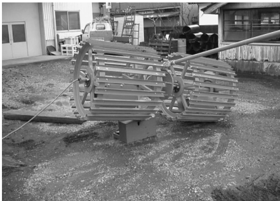
図5 障害物の昇降試験
