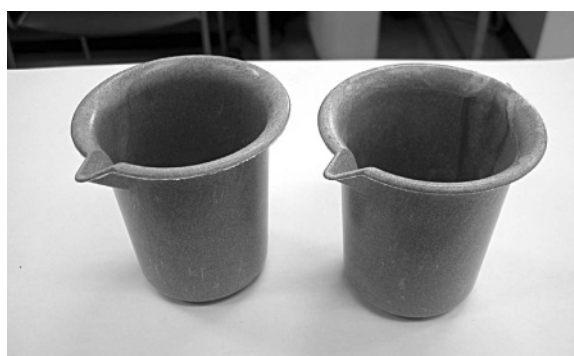
図4 脂肪酸系改質剤を添加した試料の射出成形試作品
