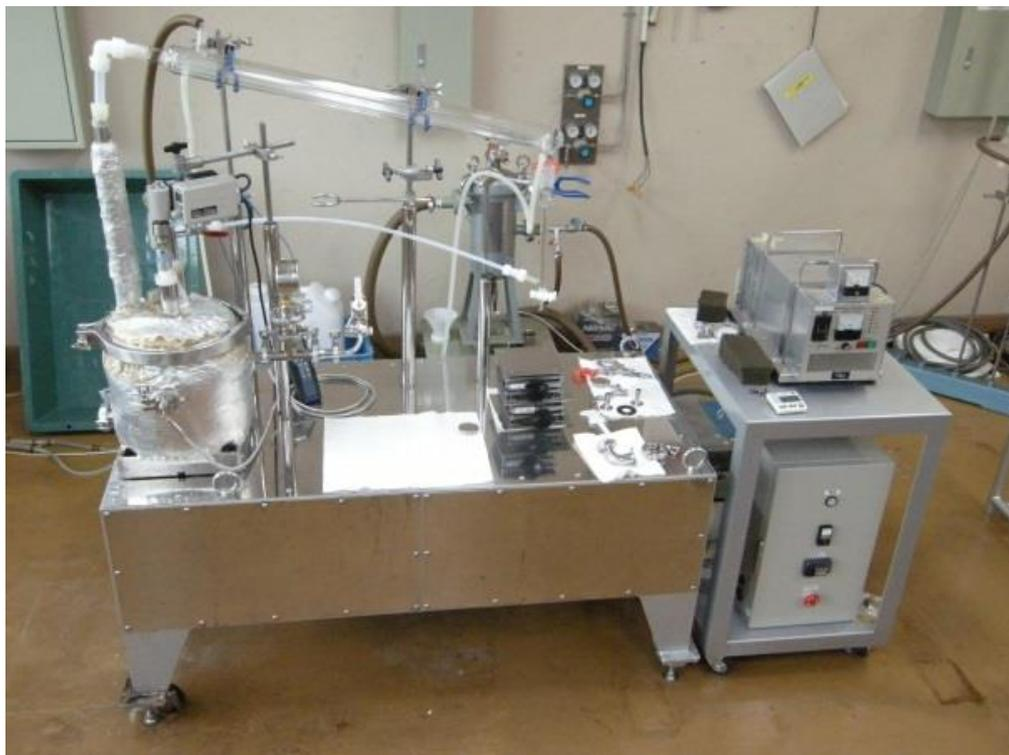
図6 ラボスケール精油抽出装置
