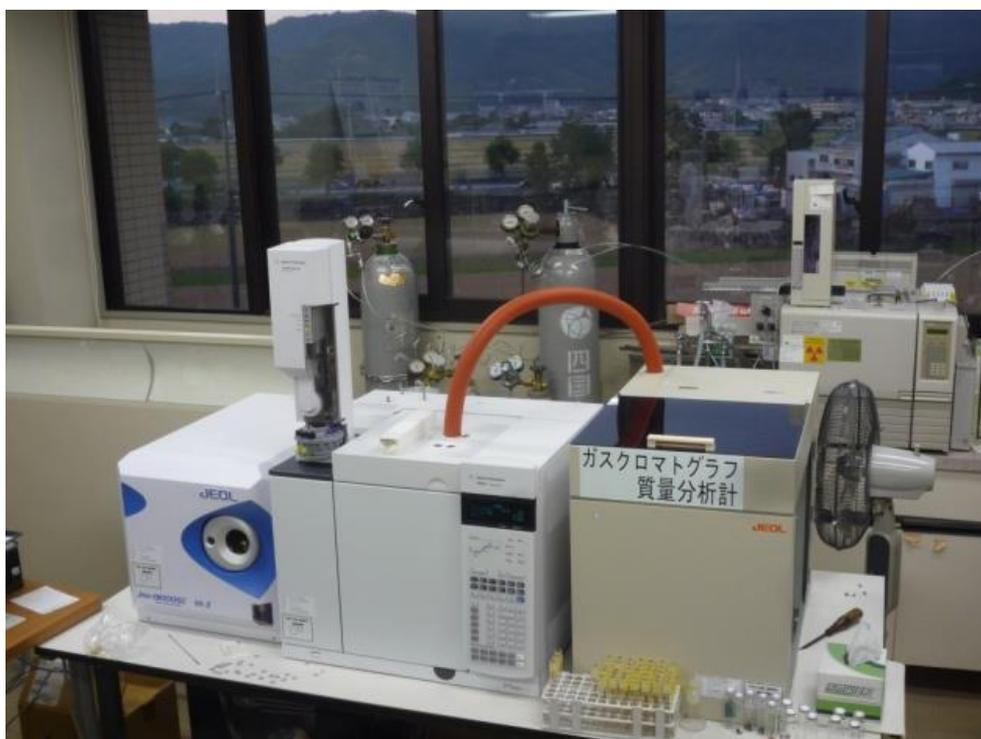
図5 ガスクロマトグラフ質量分析装置
