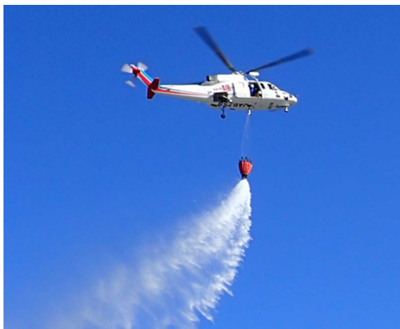
(りょうまは800リットルのバンビバケットを使用)
