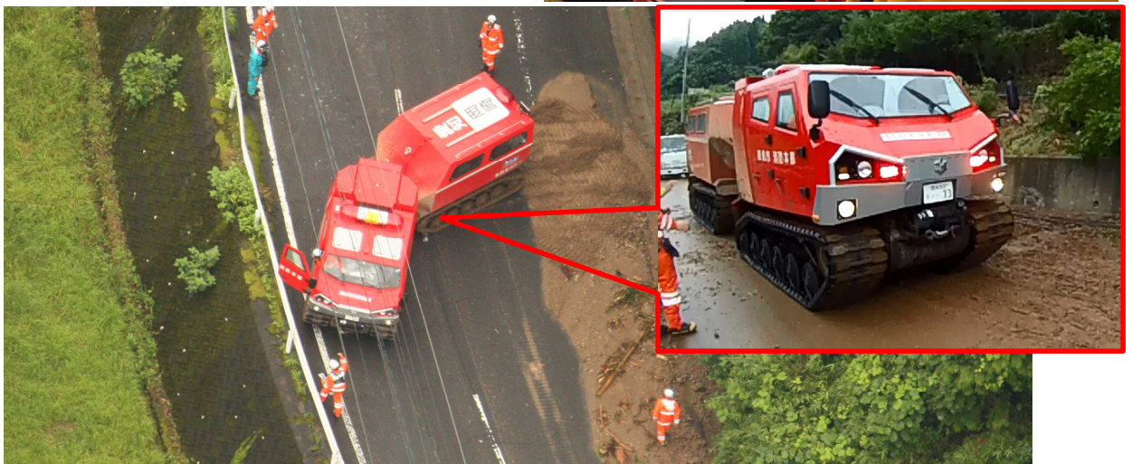
(7月7日大分県日田市で活動中の全地形対応車(レッドサラマンダー))
