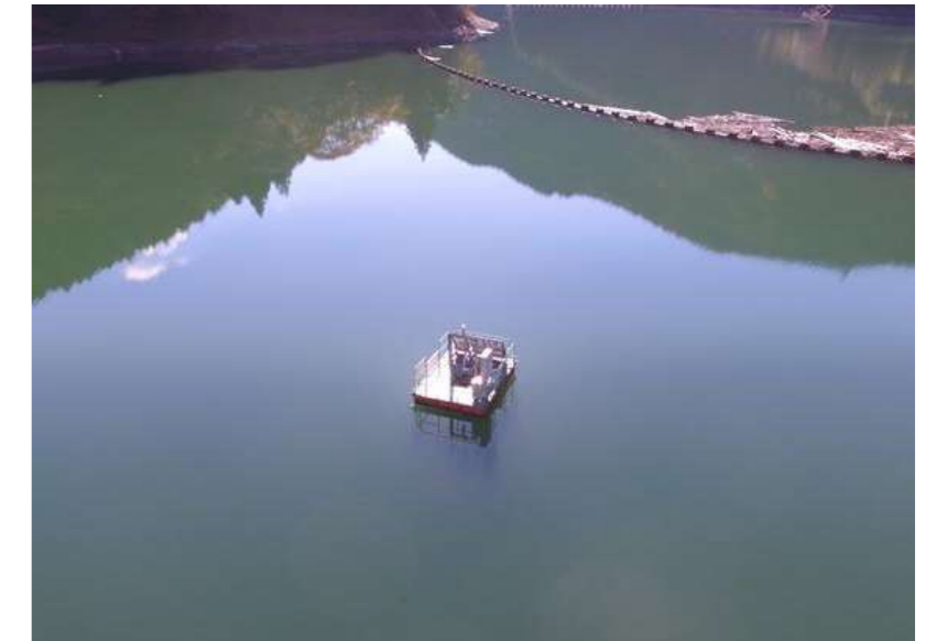
▲自動濁度計 全景
