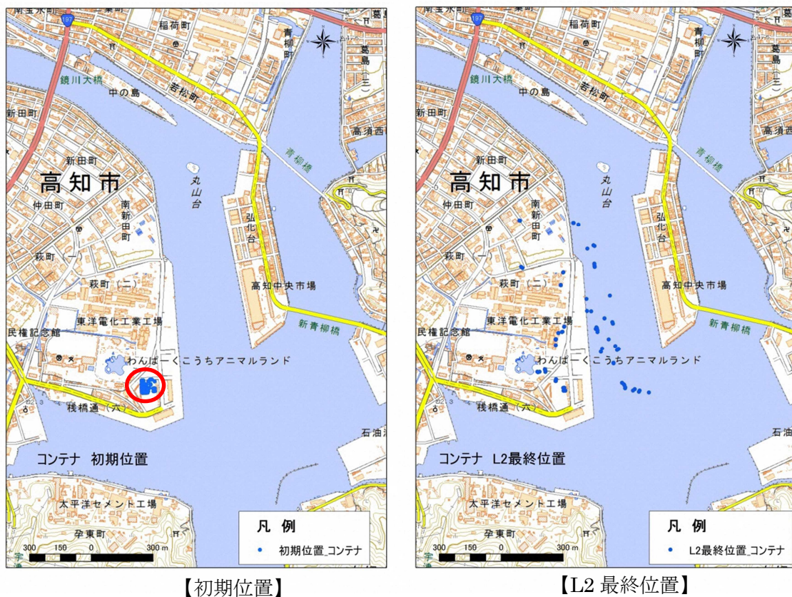
図 4.6.1 コンテナ漂流結果図
