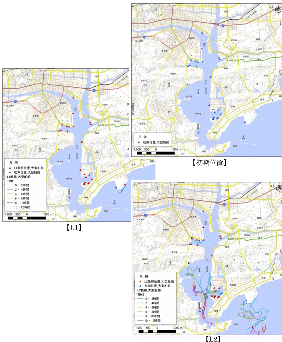
図 4.8.4 大型船舶漂流結果・軌跡図(L1、L2)
