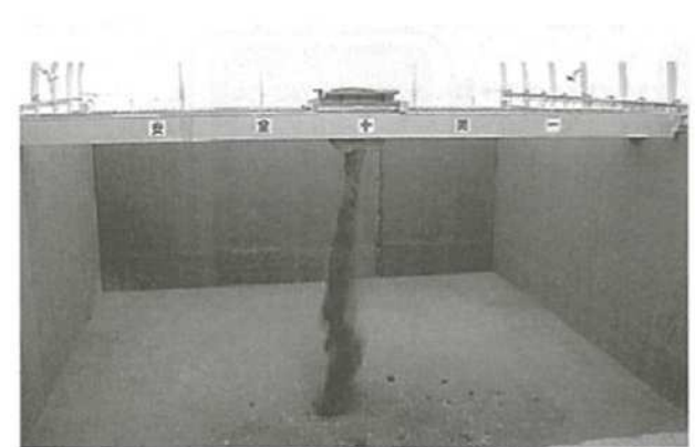
(ウ) 機械投入天井走行クラムシェル (バケットクレーン)方式
