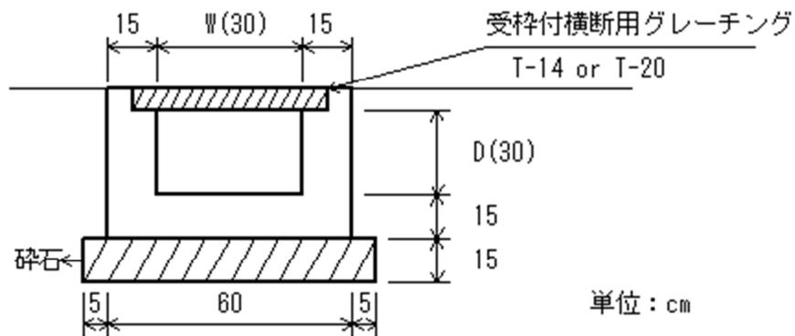
(ウ) 最小通水断面は、幅  $W=30\text{cm}$  × 深さ  $D=30\text{cm}$  とする。ただし、下流水路の関係で、流水勾配が取れない場合には、最高点の深さを  $15\text{cm}$  とすることができる。
