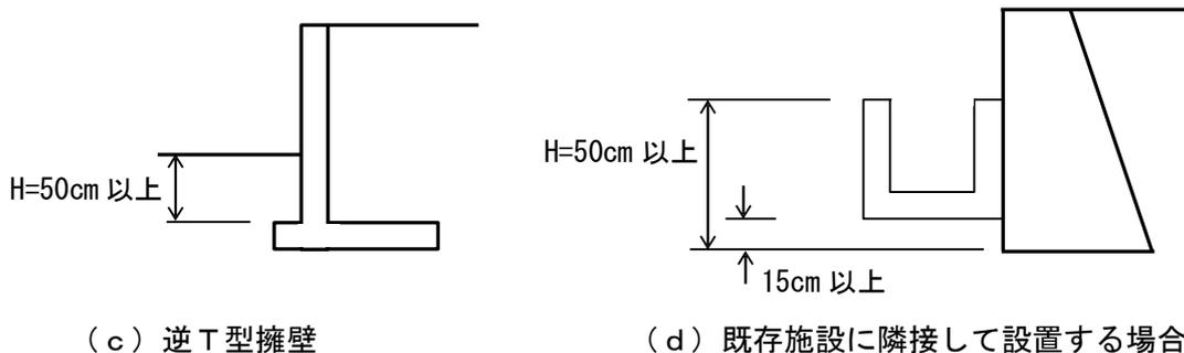
エ 擁壁の構造は、構造計算、実験等によって、平常時及び地震時において次の(ア)から(オ)までの安全性が確かめられる資料を添付すること、ただし、宅地造成等規制法施行令第15条により国土交通大臣の認定を受けた擁壁については、施工条件を満足している場合は資料の添付の必要はない。
