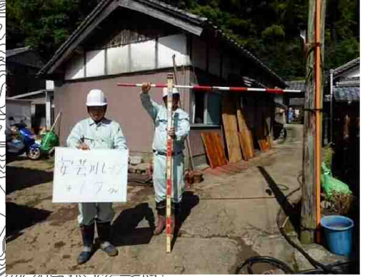
【写真：安芸川左岸（栃ノ木東地区）の被害状況（家屋床上浸水）】
