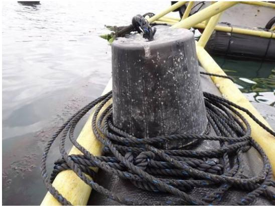
写真2 生簀用沈子
