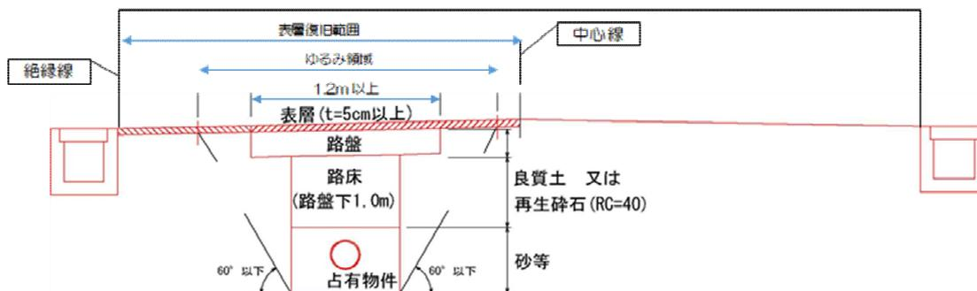
【例2】舗装幅員 4.0m 以上の道路で縦断掘削の影響幅が車道中央線未満の場合は、中央線まで復旧
