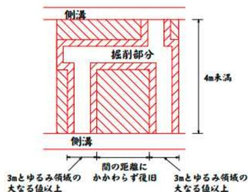
【例4】斜め掘削の復旧は、掘削影響幅を確保して道路中心線に直角に復旧
