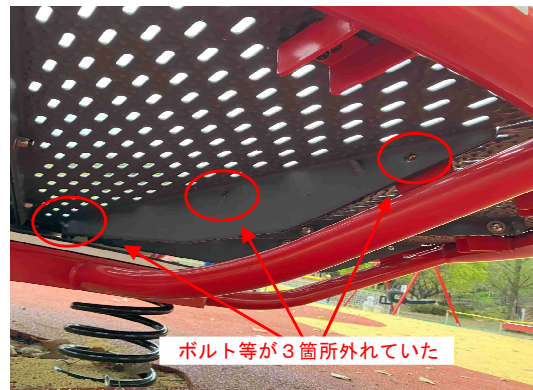
被害箇所① (スプリング遊具: 4/14被害確認)
